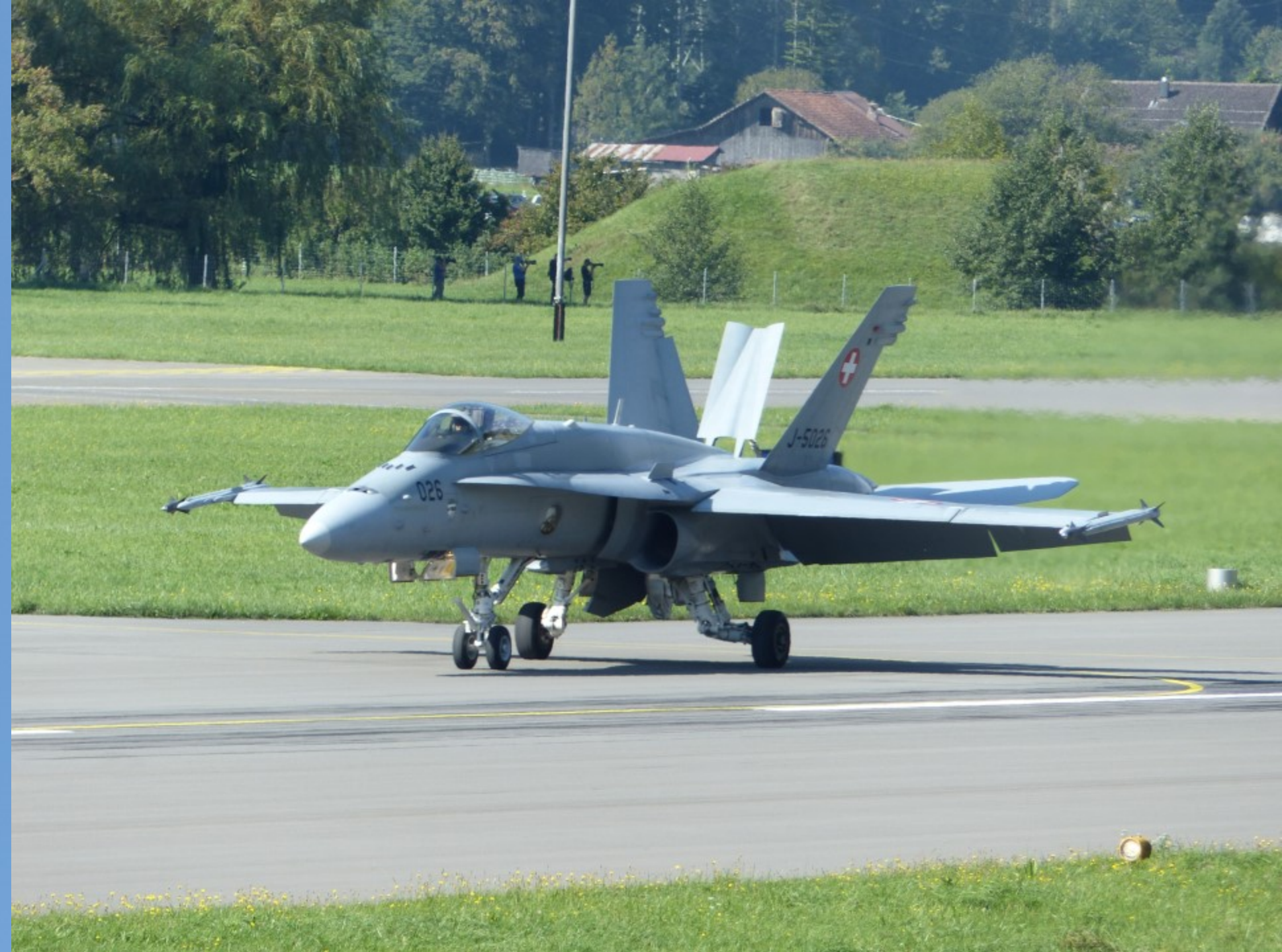
J-5026, einer der 26 Einsitzer Boeing F/A-18C mit ausgefahrener Bremsklappe, hier beim Ausrollen nach der Landung Piste 10 (11:16:30)
