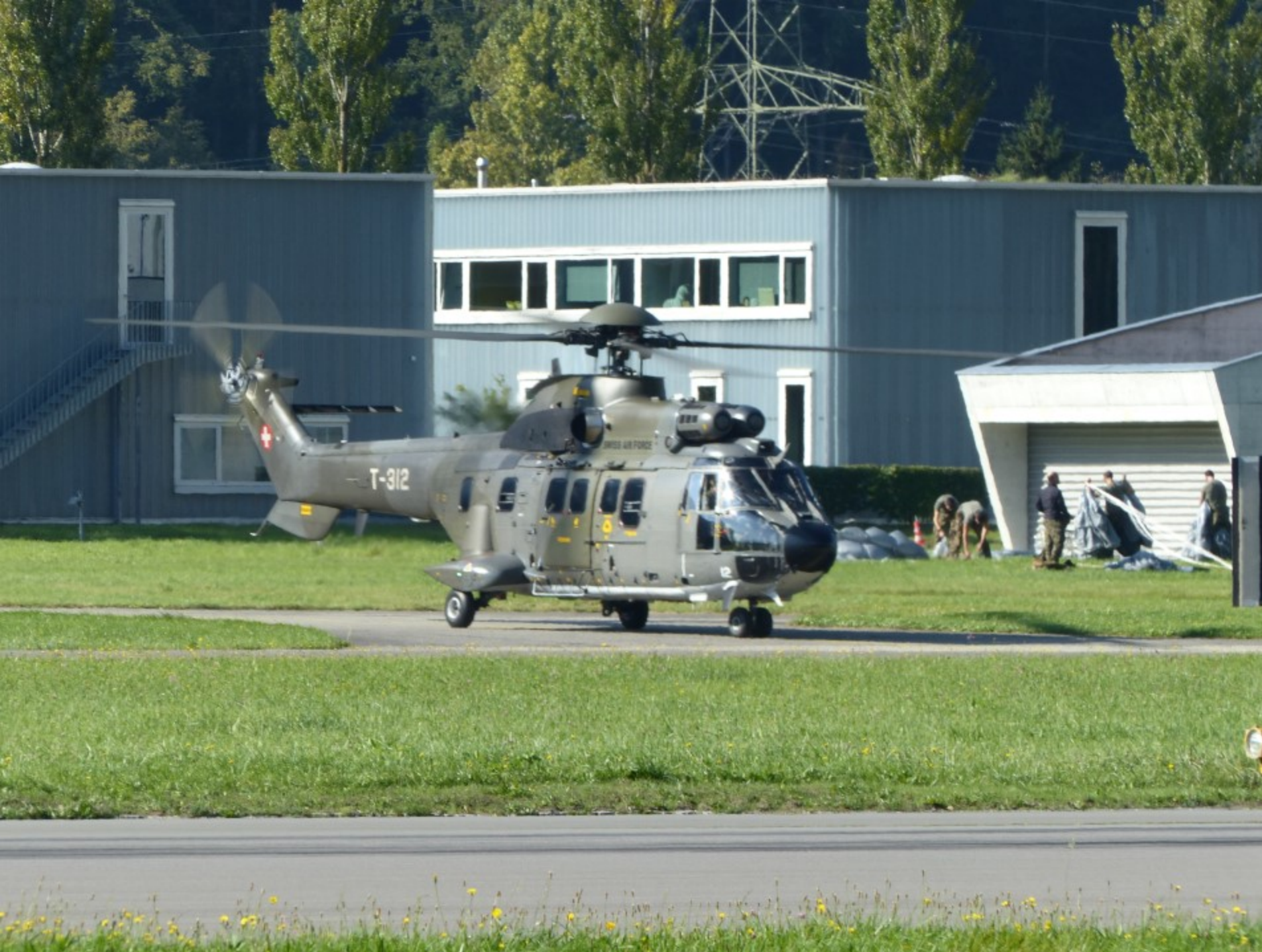
Aérospatiale AS 332M1 Super Puma (TH06), T-312, als Truppentransporter kann der TH06 zwei Piloten und achtzehn voll ausgerüstete Soldaten befördern.
